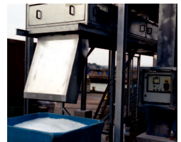
Aplicación para dosificar escamas de hielo con identificación RFID.
