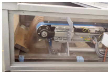
Pesaje y dosificación continua para productos granulados.
