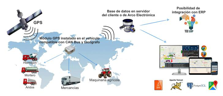
Mediante un módulo GPS instalado en el vehículo, se envía el **estado y localización** al servidor donde es mostrada al usuario a través de nuestra aplicación web adaptable a smartphone, tablet y PC.
