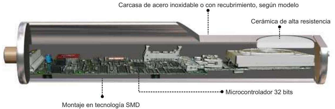
Sensor para la medición de humedad en arenas, basado en sistemas de emisión por **microondas**, realiza la lectura en el flujo del material de forma continua durante la dosificación. El medidor detecta las variaciones en los niveles de humedad permitiendo la automatización y corrección de Arenas / Agua en los procesos de hormigón.
