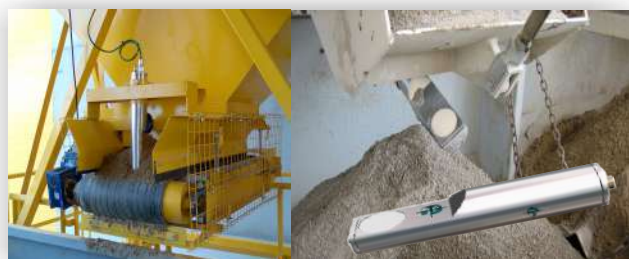
MEDICION HUMEDAD EN ARENAS - HUMIARC MEASURING MOISTURE IN SAND - HUMIARC
